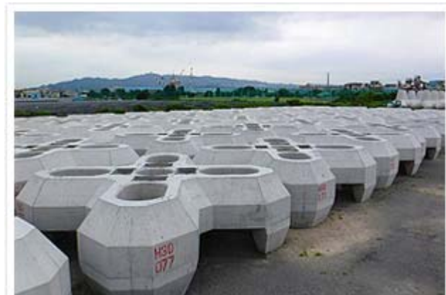
縦堤被覆ブロック
