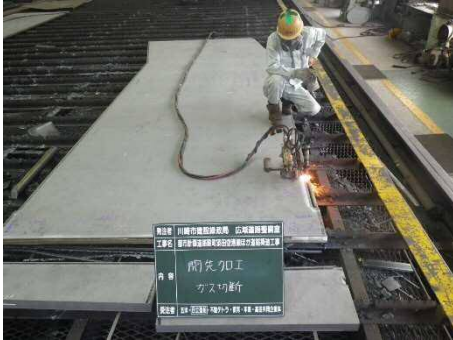
鉄板切断状況
