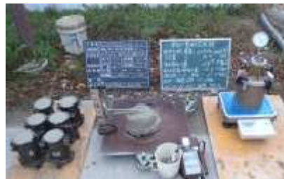
生コンクリート受入れ検査（左側6本供試体）
